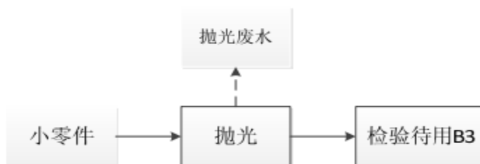
图 3.6-4 小零件处理工艺流程图
