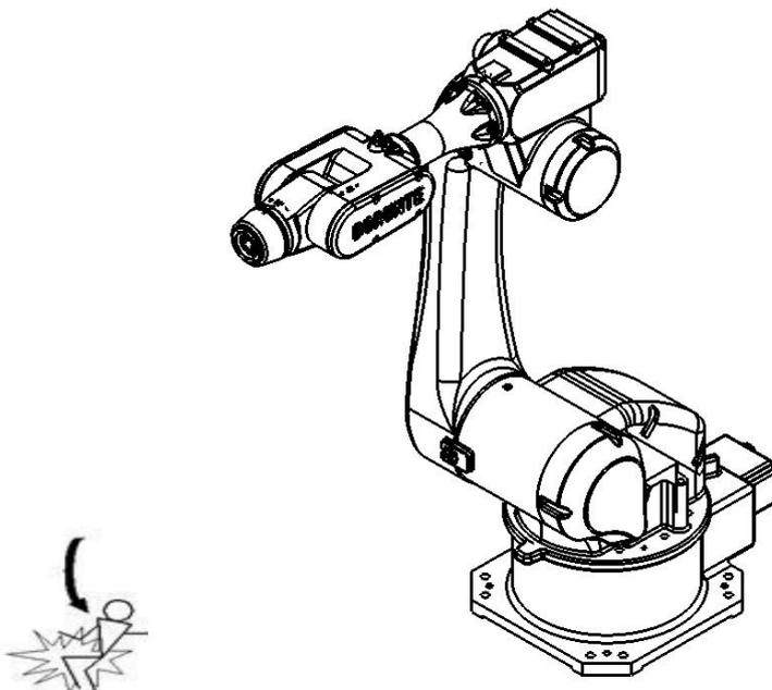
③、在末端及机械臂上安装附带机器时，应严格遵守本书规尺寸、数量的螺栓，使用扭矩扳手按规定扭矩紧固，不得使用生锈或者是有污垢的螺栓。
