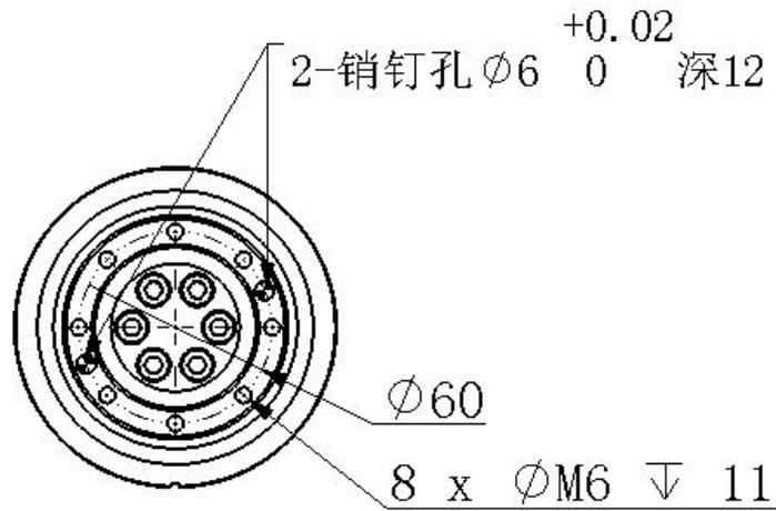
末端法兰安装孔
