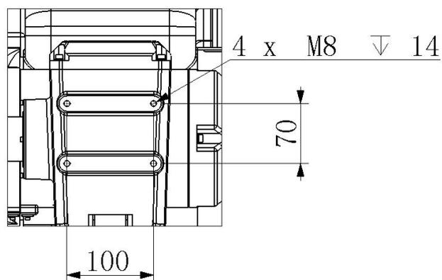
图 4.2 两吸两抱安装座孔位
