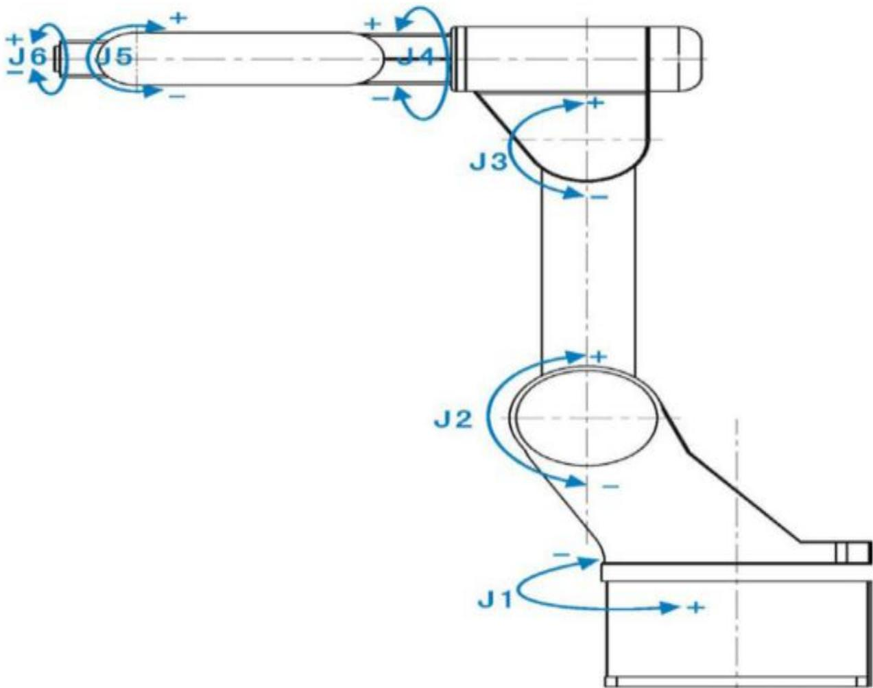
图 2.1 机器人机械系统组成图
